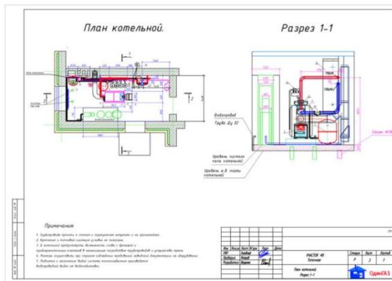
**Задание № 6.** На основании исходных данных схемы начертить план котельной и разрез 1-1 с использованием программы AutoCad.
