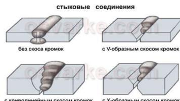
Задание 2. Определите по эскизу форму разделки кромок, рассчитайте площадь поперечного сечения шва. Подберите материалы для выполнения ручной сварки.
