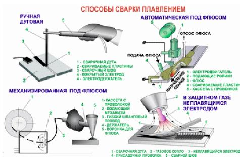
Определите вид сварки, способ сварки, сущность и назначение данного способа.
