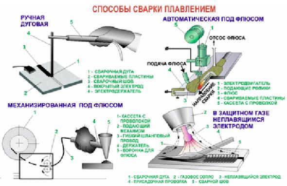
Определите вид сварки, способ сварки, сущность и назначение данного способа.
