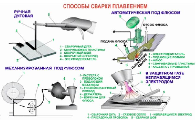
Определите вид сварки, способ сварки, сущность и назначение данного способа.
