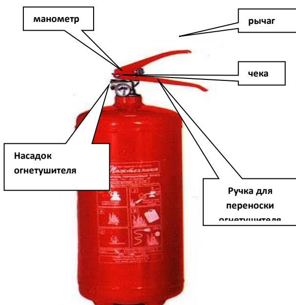
Сорвать чеку, направить насадок огнетушителя на очаг пожара, резко нажать на рычаг и быстро отпустить. Через 5 секунд повторно нажать на рычаг, направив струю порошка на огонь. Держать огнетушитель строго вертикально, не переворачивать.
