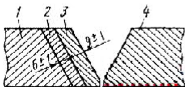
Рис.1. Схема комбинированной наплавки свариваемой кромки: 1 – углеродистая сталь; 2 – перлитный
