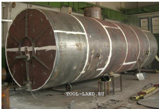
Рис.1. Цистерна, подготовленная для проверки на герметичность с использованием керосина
