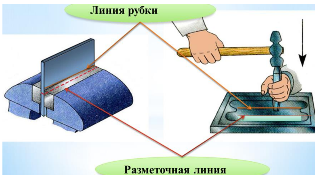
Рис. 1. Рубка полосового металла в тисках.
