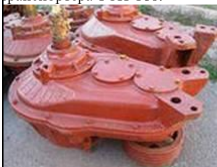
Рис. 2. Редуктор в сборе с электродвигателем привода горизонтальной части транспортера ТСН-3Б.
