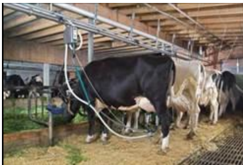
Рис. 2. АДМ-8А с молокопроводом. Состав: молокопровод, вакуумпровод, двухтактный доильный аппарат, автомат промывки или механизированная промывка, молокоприемник, пластинчатый охладитель.
