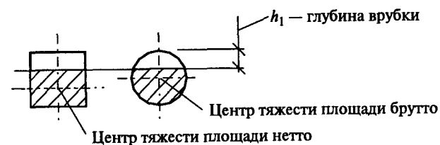
Рис. 9.16. Положение осей в узле деревянной фермы
