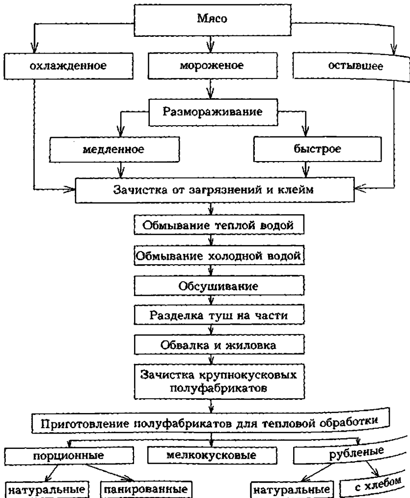
Рис. II.7. Схема механической обработки мяса
