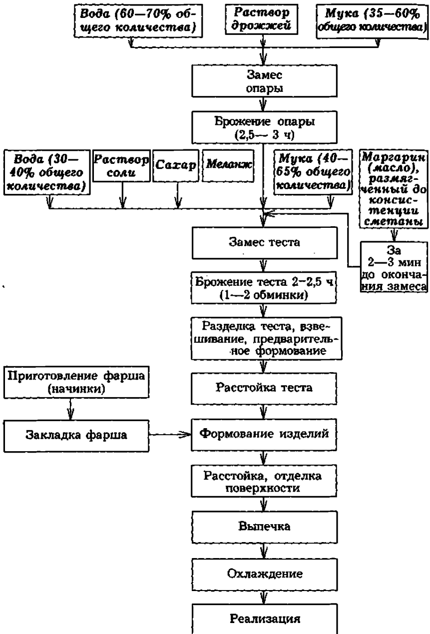
Рис. IV.4. Схема приготовления дрожжевого теста опарным способом
