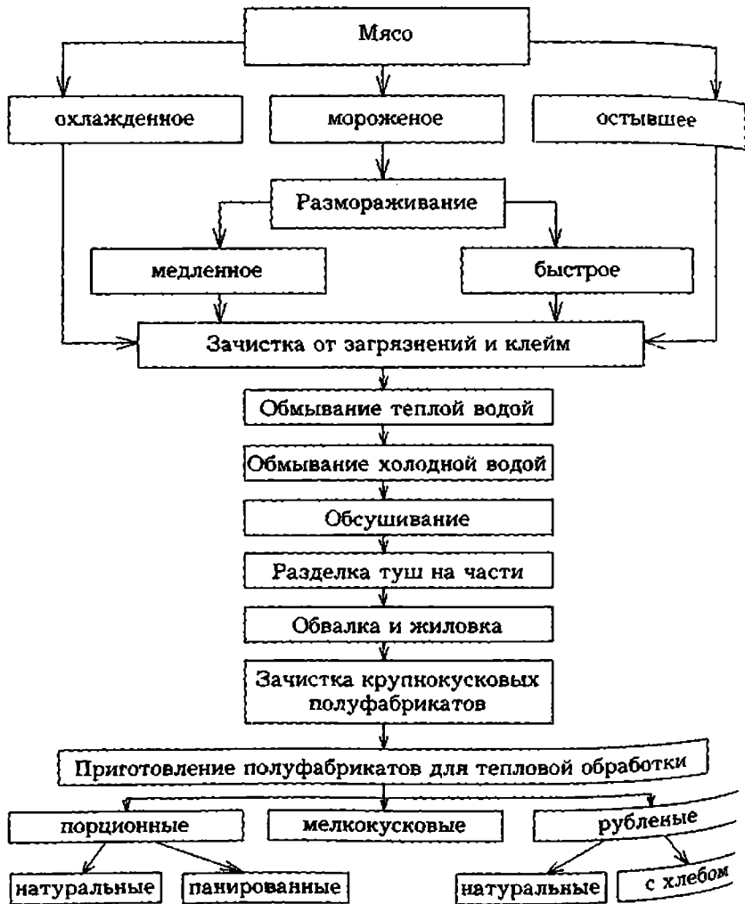
Рис. II.7. Схема механической обработки мяса
