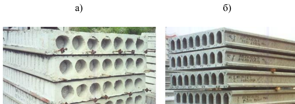
Рис.2.52. Многопустотные плиты дисков перекрытия а) - с выпусками рабочей арматуры длиной 150 мм; б) – плиты безопалубочного формования
