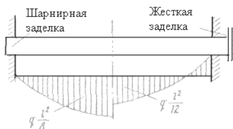
Рис.4.88. Усиление сборных железобетонных балок и прогонов путем изменения шарнирной заделки на жесткую
