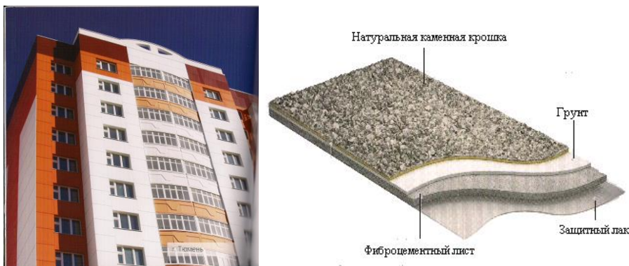
Рис. 2.119 Фрагмент фасада из облицовки фасадной плитой «Олис» (а) и фасадная плита с натуральной каменной крошкой (б)
