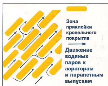
Рис.5.65. Схема отвода водяных паров из-под кровельного материала - Унифлекс «ВЕНТ»
