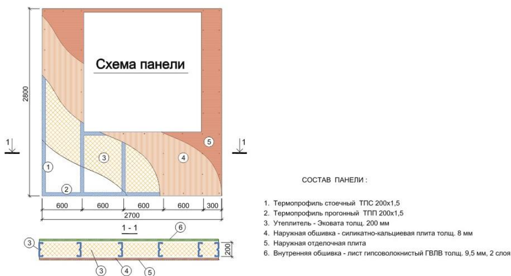
Рис.2.83. Конструктивное решение стеновой панели
