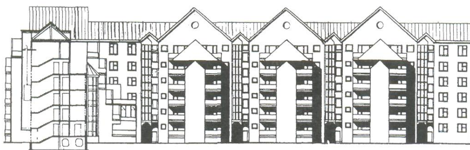
Рис.2.72. Надстройка мансардных этажей с образованием фронтонов на фасаде здания
