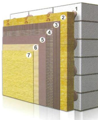
Рис.3.3. Фрагмент наружной теплоизоляции здания со штукатуркой по утеплителю:
